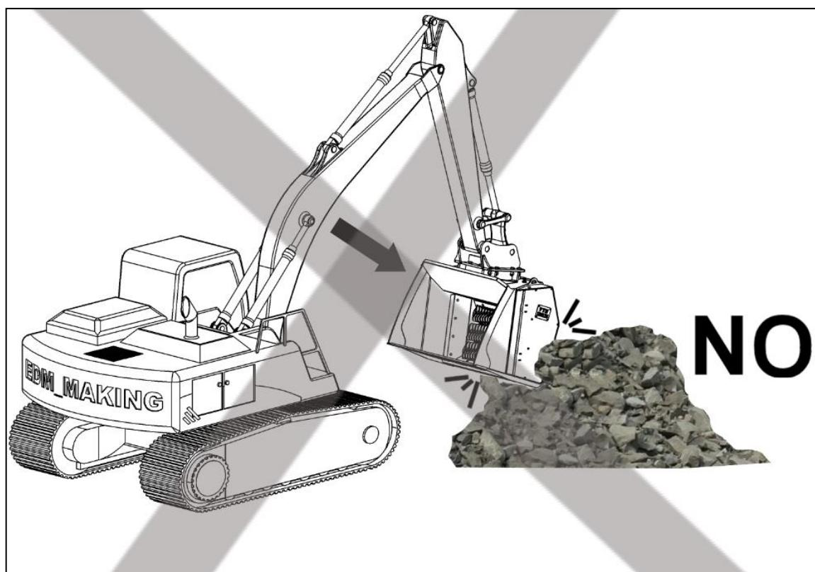
Не допустимо использование оборудования в качестве базы для вращения рабочей машины, вы можете сломать оборудование.
